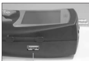
Port USB pour branchement de l'imprimante et raccordement à un PC
